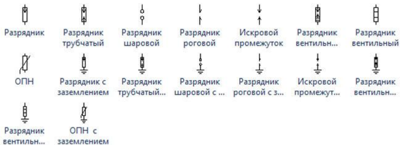
Рисунок 8 – Обозначение ОПН и разрядников на схема
